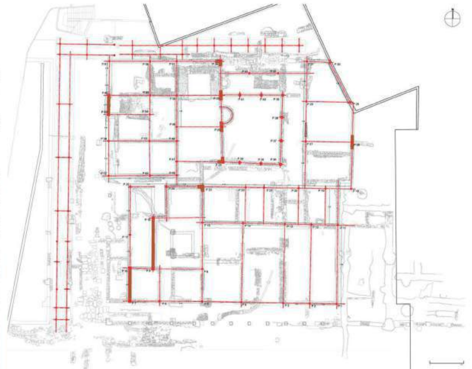
MICROESTACAS E REFORÇOS METÁLICOS EM ALIAMENTO: PAREDE ESTRUTURAL
